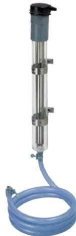
浴槽水位をチタン電極で検出し、ろ過ユニットに信号を送ります。浴槽の水位が低い場合、ろ過ユニットは空転防止の為停止し、待機します。PVC電動二方弁が開となり浴槽へのお湯を補給します。
